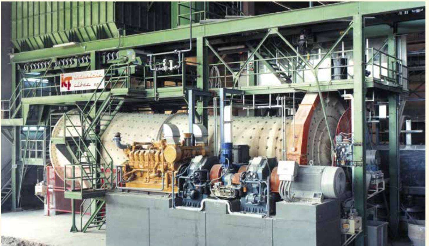
2x34 KSL, 630 kW - 1000 trs/min, broyeur à céramique (Italie)
